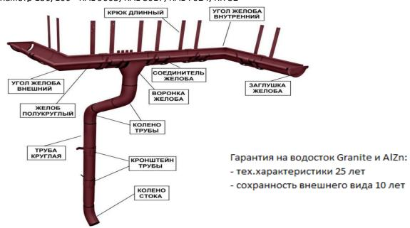
Водосточная система Grand Line® изготовлена из оцинкованной стали с двухсторонним полиуретановым покрытием Granite и покрытием Aluzinc.
